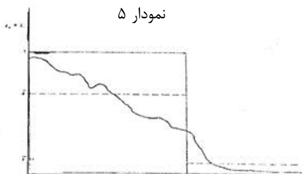
قابلیت گسیل یا جذب طیفی یک روکش انتخابی ایده آل که طول موج قطع آن \lambda_c است.
